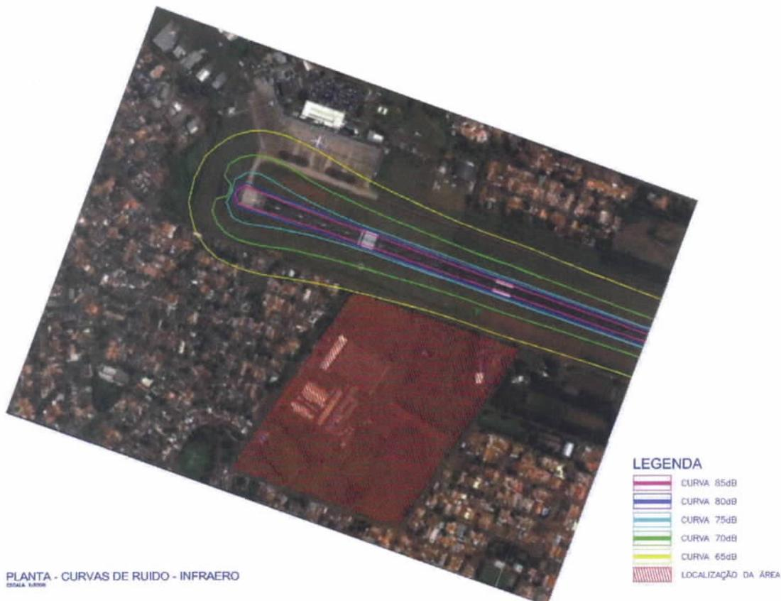
Fig. 06 – Implantação das Curvas de Ruído (conforme INFRAERO) – Fonte: INFRAERO – PLANO DIRETOR EM DESENVOLVIMENTO
